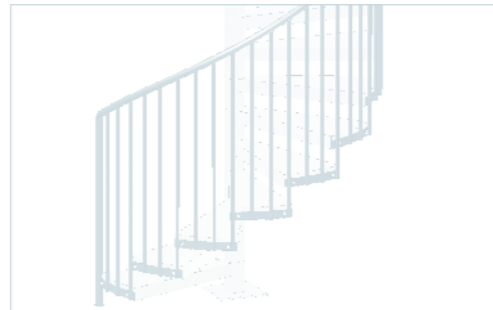
Geländer 1.0 Handlauf und senkrechte Stäbe aus Rohr, Abstand max. 120 mm im Lichten
